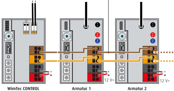
Versorgung und Bus-Leitung können auch im selben Kabel verlegt werden (4 x 1,5 mm<sup>2</sup>),
