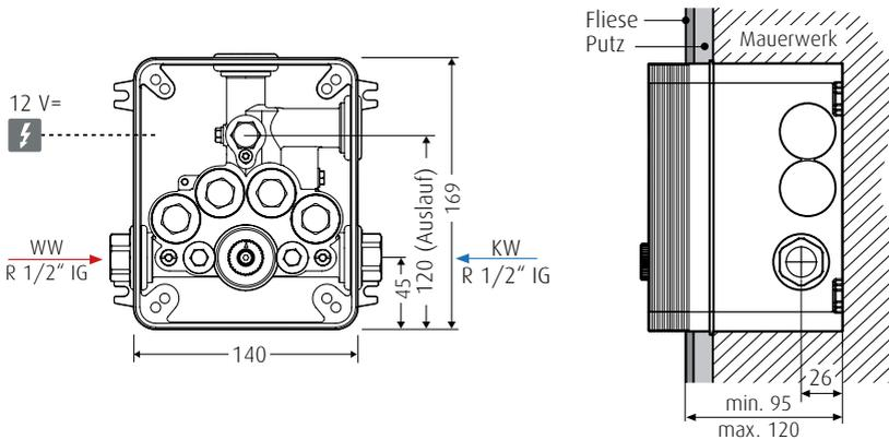
**Spannungsversorgung:** 2 x 0,5 - 1,5 mm<sup>2</sup> max. 100 m Gesamt-Kabellänge.
