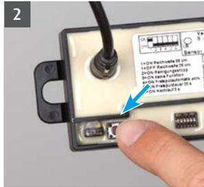
Zur Temperatureinstellung über die Taste am Elektronikmodul eine Testspülung für 1 min auslösen und währenddessen die Temperatur einstellen.
