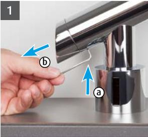
Sicherungsschraube mit beiliegendem Inbusschlüssel (SW 2) von unten gegen den Uhrzeigersinn hinein drehen und Deckel abnehmen.
