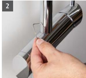
Zum Einstellen des Schwenkbereichs: Schraube hinten am Auslauf mit Inbus (SW 2) lockern und Auslauf abnehmen.
