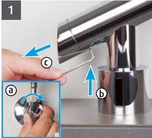
Eckventil(e) schließen. Sicherungsschraube mit beiliegendem Inbusschlüssel (SW 2) von unten gegen den Uhrzeigersinn hinein drehen und Deckel abnehmen.
