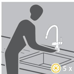
1. Das Infrarotsensor-Feld in der unteren Hälfte sanft antippen und verweilen bis der Wasserfluss startet.
