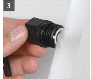
Ventilfilter unter fließendem Wasser reinigen (evt. weiche Bürste verwenden) ggf. Ventil tauschen.
