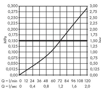
**Grundkörper 130 l/min für Abstellventil Unterputz Spindel DN20**
