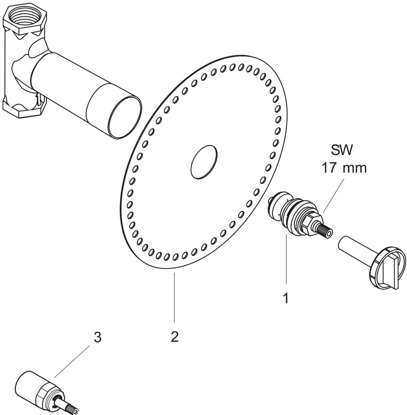
**Grundkörper 130 l/min für Abstellventil Unterputz Spindel DN20**
