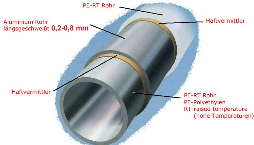
Das HERZ Kunststoff Verbundrohr PE-RT TYP II / AL/ PE-RT TYP II ist ein Mehrschicht-Aluverbundrohr für den komplexen Einsatz in Heizungs-, Kälte-, und Sanitärinstallationen. HERZ PIPEFIX wurde in Verbindung mit HERZ PIPEFIX Press- und Schraubverbindungen geprüft und wird in Rollen und Stangen geliefert.
