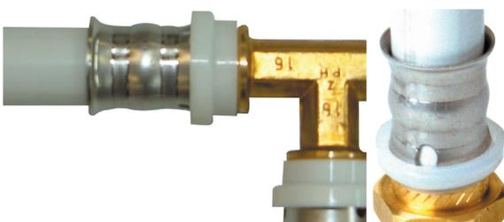
Kontrolle der Verpressung: Am Umfang der Presshülse sieht man zwei gleichlaufende, ringförmige Verpressungen. Dazwischen ist eine Aufwölbung erkennbar.
