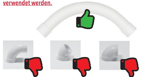
Bögen mit kleinerem Radius lassen den Schlauch nicht passieren und das Schlaucheinzug-System ist somit unbrauchbar. Bitte beachten Sie außerdem, dass der einzuziehende Schlauch maximal 5 weite 90° Depot-Bögen in der Schlauch-Einzugsleitung durchlaufen darf. Ansonsten wird die Beweglichkeit des Schlauchs in der Schlauch-Einzugsleitung eingeschränkt und das Herausziehen des Schlauches eventuell sogar unmöglich.
