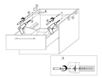
Schritt 6: Nachdem Sie den Schrank mit Schrauben an der Wand montiert haben, fixieren Sie mit einer Silikonkartusche das Waschbecken am Unterschrank. 24 Stunden trocknen lassen!
