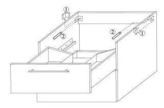
Schritt 3: Legen Sie den Schrank wieder beiseite und bohren Sie mit einer Bohrmaschine (3) einen Dübel in die Wand (wie A)
