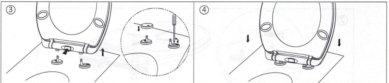
3. Nehmen Sie den WC-Sitz wieder ab. Ziehen Sie die Schrauben fest und setzen die Abdeckung auf die Scharniere.
