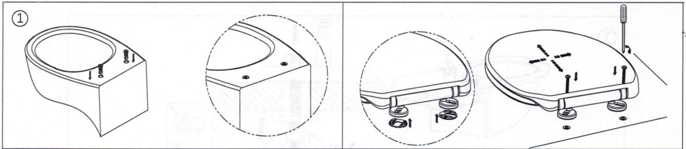
1. Setzen Sie die Spreizdübel in die Aussparung der Toilette.
