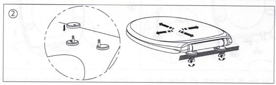
2. Setzen Sie die Scharnierabdeckung auf die Scharnierbasis und platzieren Sie den Toilettensitz mit en Stiften in den Scharnierkörper der Metallscharnierbasis. Passen Sie die Position des Toilettensitzes an, bis er perfekt auf der Toilettenschüssel sitzt und ziehen Sie die Flügelmutter vollständig an.
