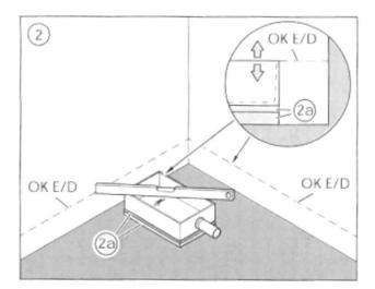
Die Oberkante der Installationsbox muss auf die geplante Oberkante Estrich/Dichtebene (OK E/D) ausgerichtet werden.
