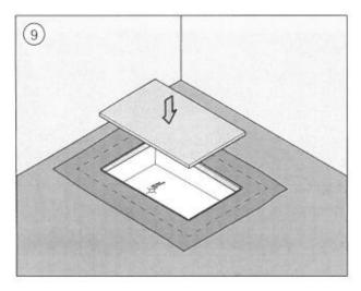
Für das Verlegen von Fiesen das Bauschutzelement wieder auf die Installationsbox aufstecken.
