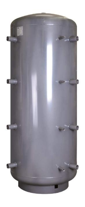
Pufferspeicher für alle Warmwasser-Zentralheizungsanlagen. Verwendbar für: Festbrennstoffe-, ölgefeuerte Heizkessel, Wärmepumpen, Solaranlagen, Gas- oder Elektrodurchlauferhitzer. Mehrere Pufferspeicher können zu einer Batterie miteinander verbunden werden. Ausgerüstet mit einem Flansch 240mm für den Einbau eines Rippenrohrwärmetauschers oder einer Elektro-Einbauheizung. Gefertigt aus Qualitätsstahl St 37-2. Pulverbeschichtung außen (Farbabweichungen)
