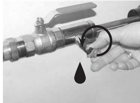
11. Entleerungsventil über Gefäß öffnen und Schleuse entleeren.
