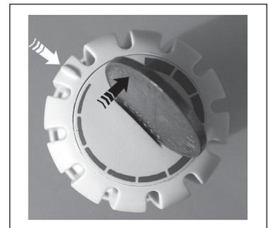
**Beispiel:** Für eine Temperaturabsenkung minus 3 K wird rechtsdrehend von der Werkseinstellung bis zur 3. Unterbrechung der blauen Markierung gedreht.
