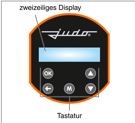
Abb. 11: Bedienfeld der Enthärtungsanlage
