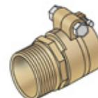
Stahl / PEX Klemmverbindung aus Messing, Übergang mit Außengewinde gemäß ÖNORM EN 10226 Zur Verbindung von PEX00 oder PEX03 Rohre (SDR 11)
