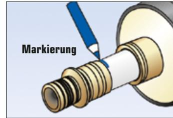
5.2 Die Stützbuchse in das Mediumrohr bis zum Anschlag einschieben.
