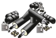
Vorisierte, geschweißte Stahl T-Stücke, egal oder reduziert, im Durchgang PEX-Einzelrohre, im Abgang PEX-DUO Rohre, 90° etagiert (bei Bestellung die Abgangsrichtung angeben), **INKLUSIVE** 6 aufgeschweißten Mediumrohrverbindungen (PEX13) und 5 Mantelrohrverbindungsmuffen (PEX40 od. PEX45) Baulänge: 1000 x 500 mm **ACHTUNG: KEINE LAGERWARE!** Dimensionen d125 und d140 mm auf Anfrage!
