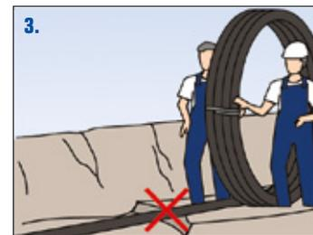
3. PEX-Ring nicht über Kanten ausrollen, die ausgerollte Leitung nicht über längere Distanzen auf dem Asphalt oder über spitze Untergründe ziehen. Dadurch können Schäden am Polyethylenschutzmantel auftreten. Schadstellen am Mantel können mittels Schrumpfschlauch behoben werden.
