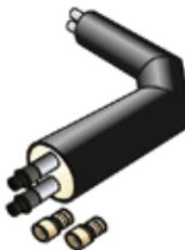
Vorisolierter, geschweißter Stahl-Bogen ST 37.0, INKLUSIVE einseitig aufgeschweißter Mediumrohrverbindung (PEX13), OHNE Mantelrohrverbindung, die in Klammer angeführten Werte stellen die tatsächlichen, konstruktiv bedingten Mantelrohr-Aussendurchmesser dar! Für die Verbindung Rohr zu Bogen sind gegebenenfalls Reduziermuffen (PEX45) zu verwenden!
