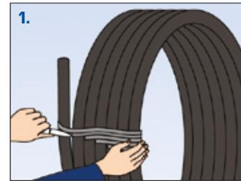
1. PEX-Ring am Beginn der Trasse platzieren und nur das äußerste Fixierband aufschneiden.
