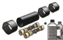
PE-HD Schrumpfmuffe lt. EN 489, doppelt dichtend mit Kleber, inkl. 3 Schrumpfmanschetten, PUR-Schaumkomponenten und Entlüftungstopfen, **INKLUSIVE** 2 Mediumrohrverbindungen PEX11
