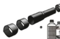
PE-HD Schrumpfmuffe laut EN 489, reduziert, doppelt dichtend mit Kleber, inkl. 3 Schrumpfmanschetten, PUR-Schaumkomponenten, Entlüftungsstopfen und PE-Muffenverschluss-Stopfen, für die Verbindung unterschiedlicher Mantelrohrdurchmesser, OHNE Mediumrohrverbindung
