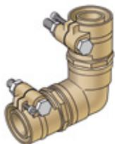
PEX / PEX Klemmverbindung 90° Bogen aus Messing. Zur Verbindung von zwei PEX05 oder PEX06 Sanitär Rohren (SDR 7,4) Reduzierte Ausführung auf Anfrage!
