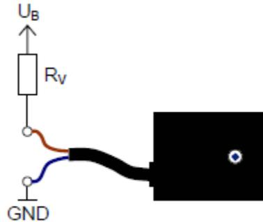
Der Sensor liefert eine Ausgangsspannung, die linear zur Sonneneinstrahlung ansteigt. Die Werte dafür sind der nachfolgenden Tabelle zu entnehmen.
