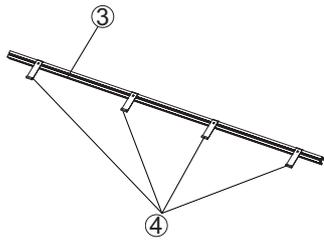
3. Die auf den Aufhängern ④ , angehängten Kollektoren, fixieren mit der Lasche ⑤ und der Schraube ⑪
