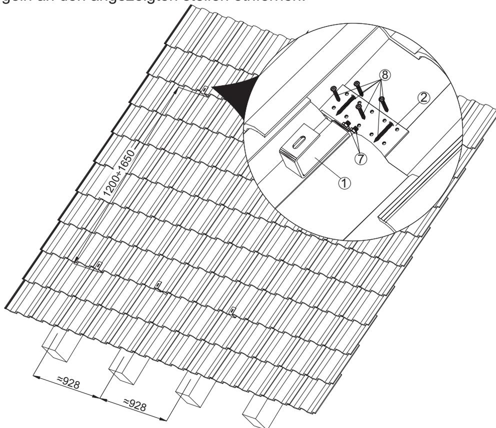
Die Haken anbringen und dan die Dachziegel wider einsetzen.
