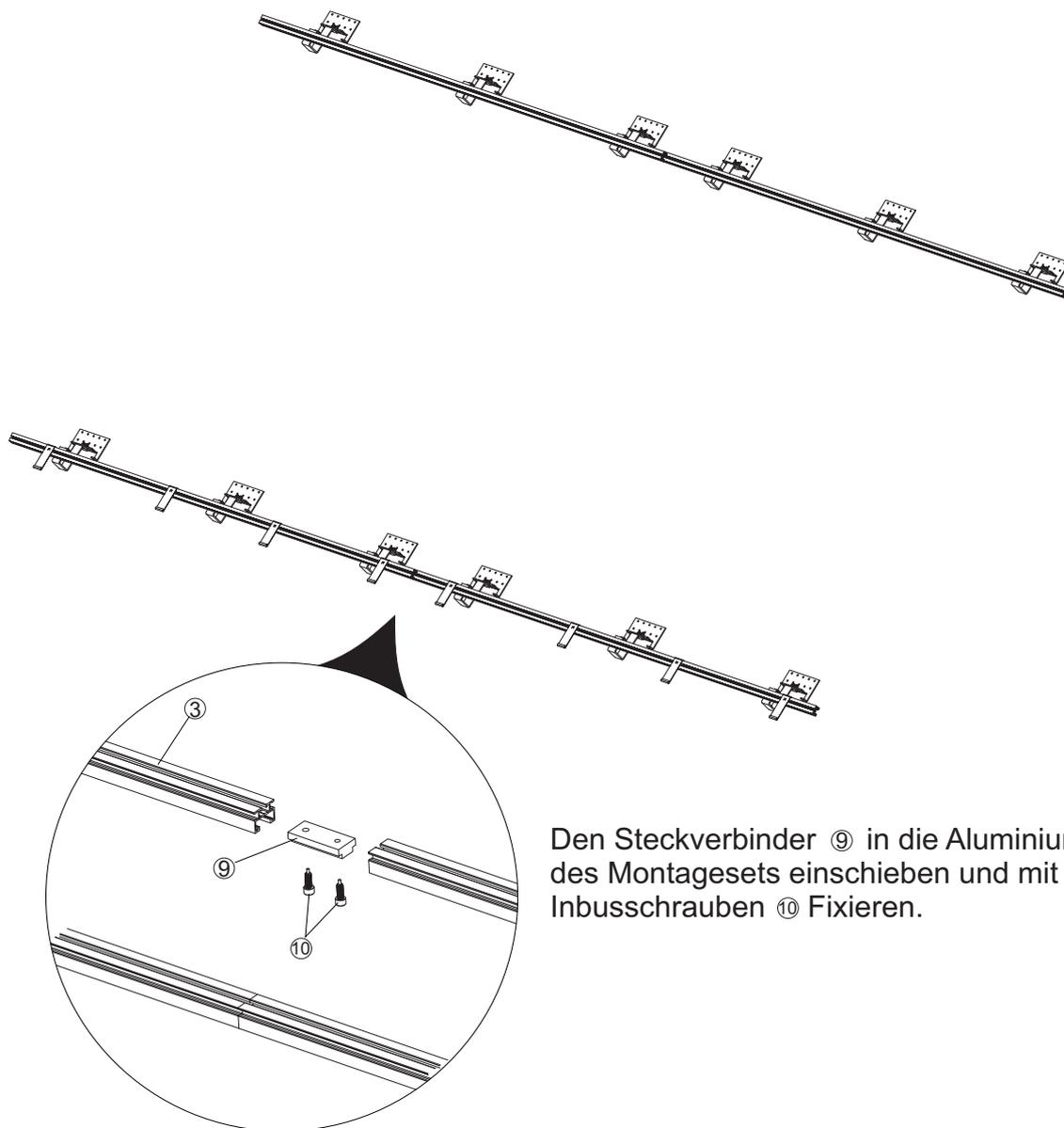
Den Steckverbinder ⑨ in die Aluminiumprofile ③ des Montagesets einschieben und mit Inbusschrauben ⑩ Fixieren.
