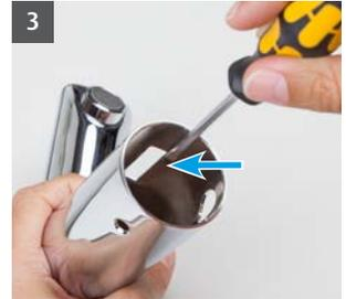
Klebrückstände auf der Innenseite der Armaturenhäube entfernen und Innenseite reinigen (für fettfreie Oberfläche sorgen).
