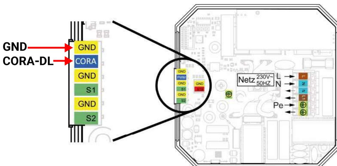
Auf die Polung muss geachtet werden. Der Anschluss **CORA** des Heizstabs wird mit **DL** am Regler verbunden, sowie **GND** mit **GND**.
