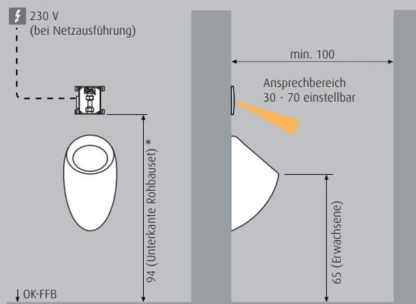
Bei 230 V Netzbetrieb Elektro-Leerverrohrung vorsehen.
