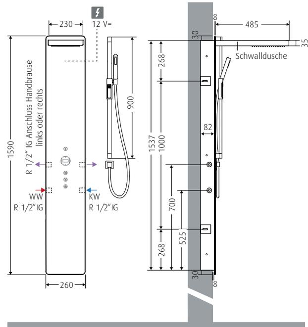
**Spannungsversorgung:** 2 x 0,5 - 1,5 mm<sup>2</sup> max. 10 m Gesamt-Kabellänge.
