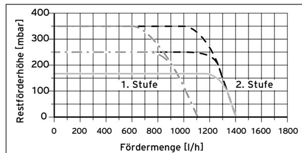
Pumpenkennlinie (2-stufig automatisch umschaltende Heizkreispumpe)
