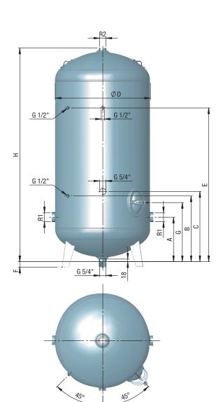
Die Windkessel / Druckwasserkessel der Typenreihe WK sind aus Qualitätsstahl nach EN-Normen hergestellt und eignen sich hervorragend zum Einsatz in Trink- und Betriebswassernetzen. Besonders zur Dämpfung von Druckstößen in Netzen, beziehungsweise zur Aufrechterhaltung eines konstanten Leitungsdruckes, sind die Behälter mit einem Inhalt von 150 bis 500 Liter bestens geeignet.
