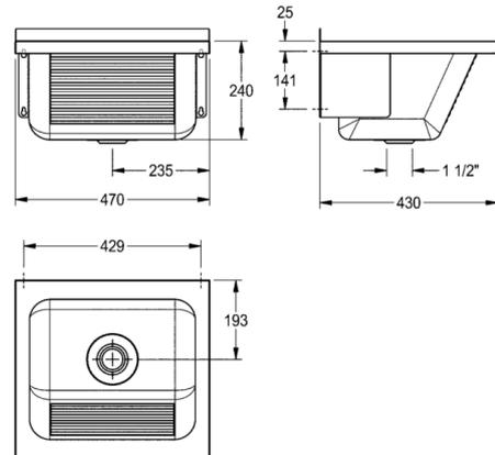
Universalwaschtrog, zur Wandmontage, Chromnickelstahl, Oberfläche seidenmatt, Materialstärke 0,8 mm, Frontschürze mit Längsrieffel, ohne Armaturenbank, Ablauf mittig, Stopfenab- und Überlaufgarnitur G 1 1/2 B mit Überlauf, mit hinterer Aufkantung 30 mm (H), angeschweißten Konsolen, inklusive Befestigungsmaterial.
