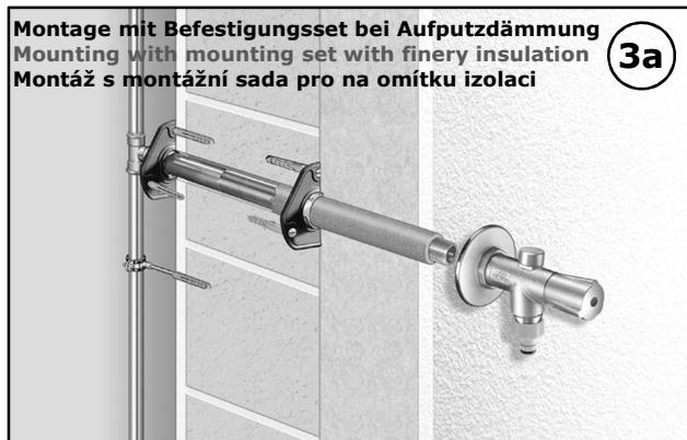
Befestigungsset bei Außenwand mit starker Außenwanddämmung
