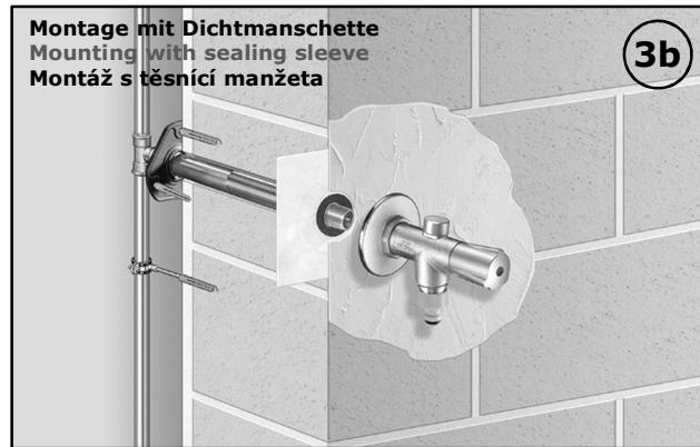
Dichtmanschette; selbstklebend und feuchtigkeitsfest zur Anwendung als Dampfsperre auf der Innenwand und als Tropfwasserdichtung auf der Außenwand
