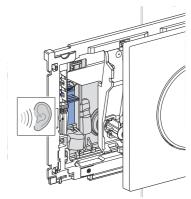
✓ Der Geberit DuoFresh Stick löst sich vom Halter und fällt in den Spülkasten. 5 Betätigungsplatte nach links schwenken (1) und leicht nach hinten drücken (2), bis sie spürbar einrastet.
