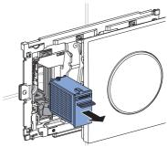
3 Schublade mit Filter entsorgen und neue Schublade bereithalten.
