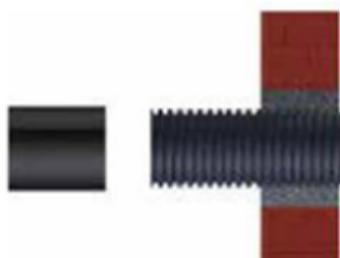
Die Schrumpfmuffe wird über die Mauerhülse geschoben. **AUF KEINEN FALL IN LÄNGSRICHTUNG DURCHSCHNEIDEN!**
