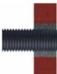
Die Mauerhülse wird eingemauert, wobei 10 cm aus der Außenmauer hervorragen müssen.
