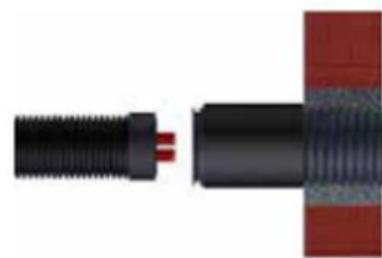
Das Austroflex-Rohr wird durch die eingemauerte Mauerhülse geschoben.
