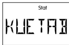
Kollektor – Übertem- peratur – Abschal- tung ist aktiv
