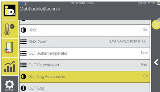
Zur Überprüfung der Kommunikation den Parameter „GLT Log Einschalten“ aktivieren. Dieser Parameter wird nach einer Stunde wieder automatisch zurückgesetzt.
