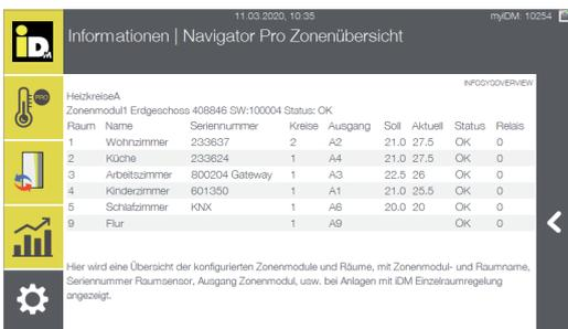
Bei Räumen mit KNX-Raumsensor wird bei der Seriennummer „KNX“ angezeigt. Die aktuelle Raumtemperatur muss über den jeweiligen Datenpunkt kommuniziert werden, z.B. für Raum 5 wäre das der Datenpunkt 522.
