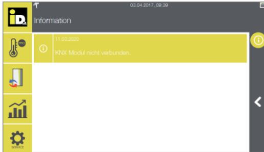
Bei dem in der Navigatorregelung konfiguriertem EIB/KNX-Modul, erscheint bei Problemen mit der Netzwerkverbindung die Störmeldung „*KNX-Modul nicht verbunden*“.
