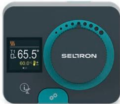
Festwertregler ACD dienen für die Regelung der konstanten Temperatur in der Rohrleitung. Der Regler wird mithilfe der Tastatur und Grafikdisplay eingestellt, welcher auch für die Anzeige der gemessenen Temperatur, sowie andere Daten, dient. Integrierter Stellmotor wird für die Steuerung des Mischventils verwendet. Der Regler wird über ein Kabel mit Stecker an die Stromversorgung angeschlossen.
