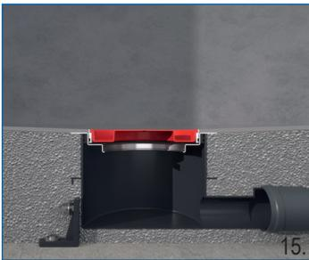
DE Bündiger Abschluss der Beschichtung mit dem Edelstahlaufsatzring.
