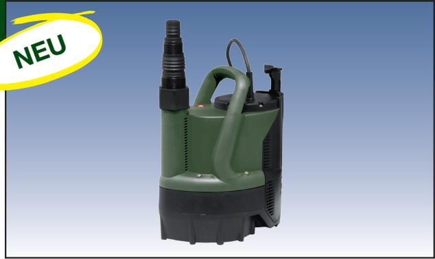
Tauchmotorpumpen speziell für die Anwendungen in engen Gruben konzipiert mit seitlich integriertem Schwimmerschalter, für die automatische Ein- und Ausschaltung. Druckstutzen nach oben. Flach absaugend bis 2 mm. Automatischer und manueller Betrieb möglich. Einbauschaft nur 200 x 200 mm. Max. Korngröße 5 mm. Ideale Motor- kühlung durch das Medium. Mit 10 m Kabel und Stecker, sowie vielseitigen Druckstutzen mit Rückschlagklappe. Antikorrosion und rostfreie Materialien.
