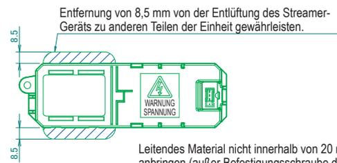
Entfernung von 8,5 mm von der Entlüftung des Streamer-Geräts zu anderen Teilen der Einheit gewährleisten.
